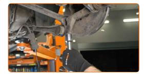
Ziehen Sie die Befestigungen an, die den Querlenker mit dem Hinterachsgelenk verbinden. Verwenden Sie Stecknuss Nr. 15. Verwenden Sie einen Drehmomentschlüssel. Ziehen Sie ihn mit 103 Nm Drehmoment fest.
