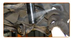
Befestigen Sie den Stoßdämpfer am hinteren Achsschenkel.
