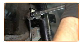
Behandeln Sie die Federbein-Befestigungen. Behandeln Sie alle Gelenke der Koppelstange. Behandeln Sie die Befestigungen des hinteren Achsschenkels. Benutzen Sie ein Kupferschmiermittel.
