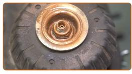
Dekomprimieren Sie die Feder.
