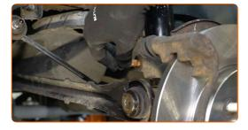
Schrauben Sie die Befestigung an, die den Stoßdämpfer mit dem hinteren Achsschenkel verbindet. Verwenden Sie Stecknuss Nr. 18. Verwenden Sie einen Ratschenschlüssel.
