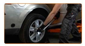
Entfernen Sie den Wagenheber sowie die Unterlegkeile.
