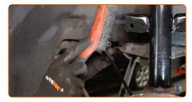
73 Montieren Sie den Querlenker.
