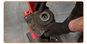
Ziehen Sie die Federbeinkolbenstangenmutter an. Verwenden Sie Stecknuss Nr. 19. Verwenden Sie Inbusschlüssel Nr. H6. Verwenden Sie einen Drehmomentschlüssel. Ziehen Sie ihn mit 50 Nm Drehmoment fest.
