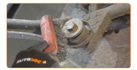
Schrauben Sie die Befestigung heraus, die den Querlenker mit dem Hinterachsgelenk verbindet. Verwenden Sie Stecknuss Nr. 15. Verwenden Sie einen Ratschenschlüssel.
