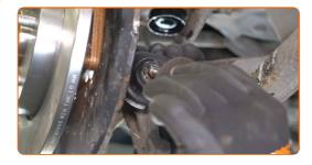
Schrauben Sie die Befestigungen ein, die den Querlenker mit dem Hinterachsgelenk verbinden. Verwenden Sie Stecknuss Nr. 15. Verwenden Sie einen Ratschenschlüssel.
