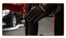
Installieren Sie die Feder am Stoßdämpfer.
