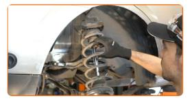
Stellen Sie das Dämpferbein auf das Federspannwerkzeug.
