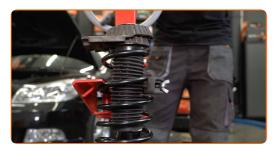
Entfernen Sie das zusammengebaute Federbein.
