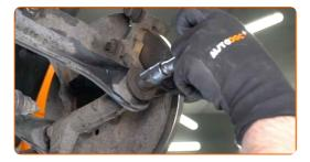
Ziehen Sie die Befestigung, die das Federbein mit dem hinteren Achsschenkel verbindet, fest. Verwenden Sie Stecknuss Nr. 18. Verwenden Sie einen Drehmomentschlüssel. Ziehen Sie ihn mit 85 Nm Drehmoment fest.
