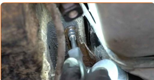
**20** Reinigen Sie den Kraftstofffilter. Verwenden Sie Allzweckreinigungsspray.
