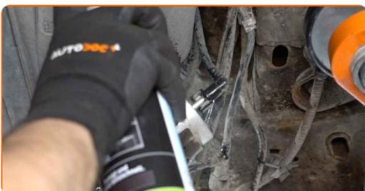
**11** Trennen Sie die Kraftstoffversorgungsleitungen vom Kraftstofffilter.
