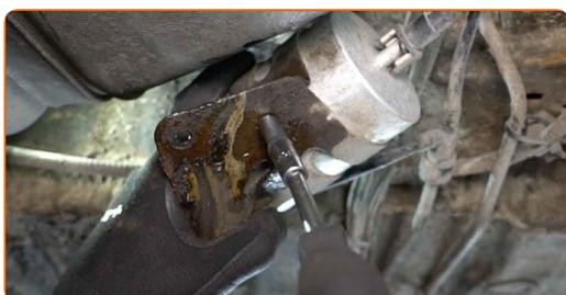
**8** Entfernen Sie den Befestigungswinkel des Kraftstofffilters.
