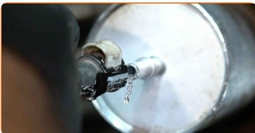
**12** Entfernen Sie den Kraftstofffilter.
