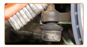
Beim Deinstallieren sollten Sie die genaue Position des Kugelgelenks an der Spurstange markieren oder messen oder zählen Sie die Anzahl der Windungen, um danach eine Fehlausrichtung zu vermeiden. Verwenden Sie einen Messschieber.
