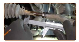
Lösen Sie die Kontermutter, die den Spurstangenkopf auf der Spurstange fixiert. Verwenden Sie Ring-Gabelschlüssel Nr. 17. Verwenden Sie Ring-Gabelschlüssel Nr. 19.
