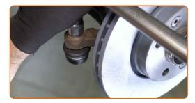
Ziehen Sie die Spurstangenkopf Sicherungsmutter an. Verwenden Sie Ring-Gabelschlüssel Nr. 17 (2 Teile). Verwenden Sie einen Drehmomentschlüssel. Ziehen Sie ihn mit 50 Nm Drehmoment fest.
