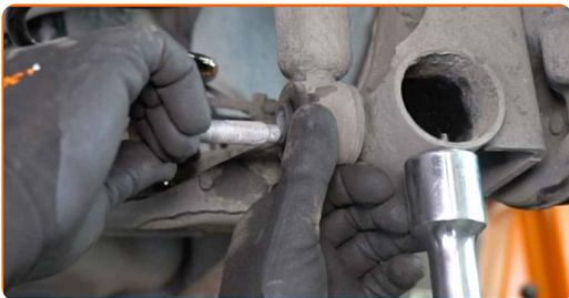
**20** Schrauben Sie das untere Befestigungselement des Stoßdämpfers ein. Verwenden Sie Stecknuss Nr. 16. Verwenden Sie einen Ratschenschlüssel.
