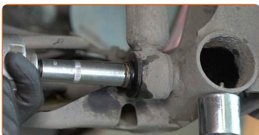
**13** Entfernen Sie die Befestigungsschraube.
