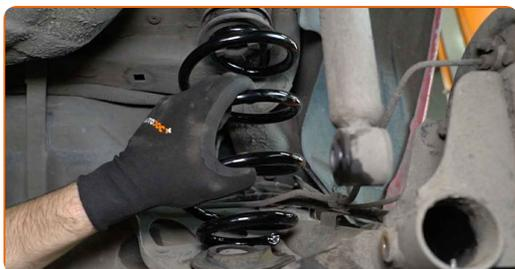
**18** Stützen Sie die Verbundlenkerachse. Benutzen Sie einen hydraulischen Getriebeheber.
