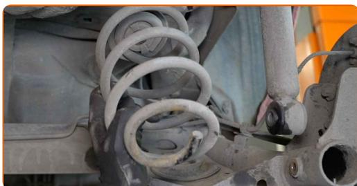
**16** Reinigen Sie die Montagesitze der Federn. Benutzen Sie eine Drahtbürste. Verwenden Sie Allzweckreinigungsspray.
