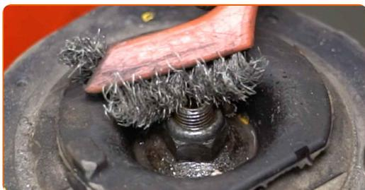
**29** Entfernen Sie die Mutter des Federbeinkolbens. Verwenden Sie eine 18 mm Schienenmutterstecknuss. Verwenden Sie Inbusschlüssel Nr. H6. Verwenden Sie einen Ratschenschlüssel.
