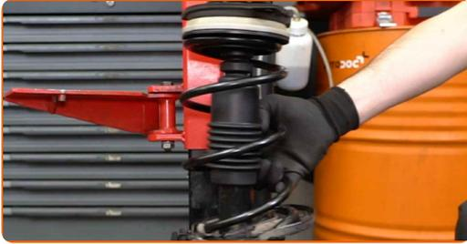
**42** Reinigen Sie die Anbringungssitze des Federbeins. Benutzen Sie eine Drahtbürste. Verwenden Sie Allzweckreinigungsspray.
