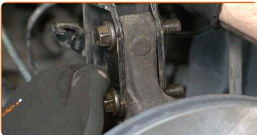
**47** Befestigen Sie den Bremsschlauch am Federbein.
