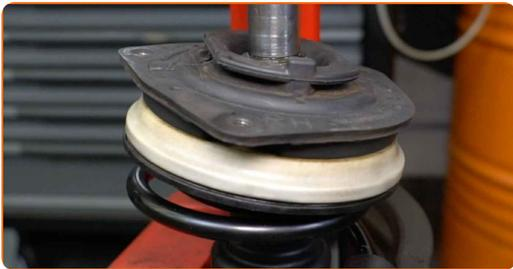
**39** Schrauben Sie die Kolbenstangenmutter des Federbeins fest. Verwenden Sie eine 18 mm Schienenmutterstecknuss. Verwenden Sie Inbusschlüssel Nr. H6. Verwenden Sie einen Drehmomentschlüssel. Ziehen Sie ihn mit 68 Nm Drehmoment fest.
