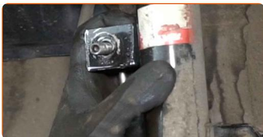
**53** Ziehen Sie das Befestigungselement an, das die Druckstange mit dem Federbein verbindet. Verwenden Sie Stecknuss Nr. 17. Verwenden Sie einen Drehmomentschlüssel. Ziehen Sie ihn mit 44 Nm Drehmoment fest.
