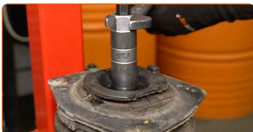
**30** Entfernen Sie das obere Federbeinlager.
