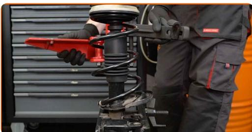
**41** Entfernen Sie das zusammengebaute Federbein.
