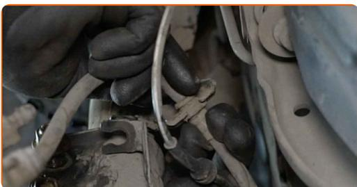
**48** Den Halteclip des Bremsschlauchs anbringen. Benutzen Sie einen Hammer.
