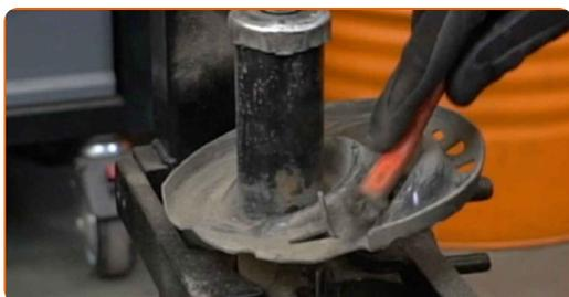
**35** Bauen Sie die Staubmanschette und den Anschlagpuffer auf dem Stoßdämpfer ein.
