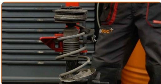
**28** Reinigen Sie die Kolbenstange des Federbeins. Benutzen Sie eine Drahtbürste. Benutzen Sie WD-40-Spray.
