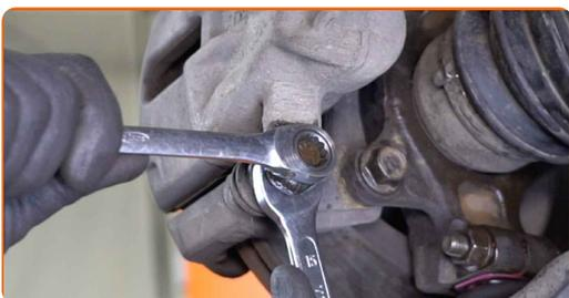
**11** Entfernen Sie die Befestigungsschrauben.
