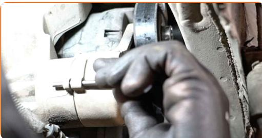
**5** Entfernen Sie den Keilrippenriemen.
