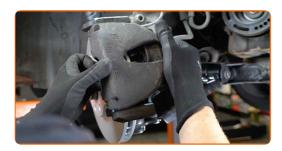
Installieren Sie die Staubschutzkappen der Bremssattel-Führungsstifte.
