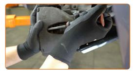
Entfernen Sie den Bremssattel.
