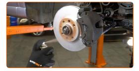
Die Bremsscheibenoberfläche reinigen. Benutzen Sie einen Bremsenreiniger.
