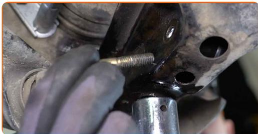
**22** Lösen Sie die Koppelstange vom Achslenker.
