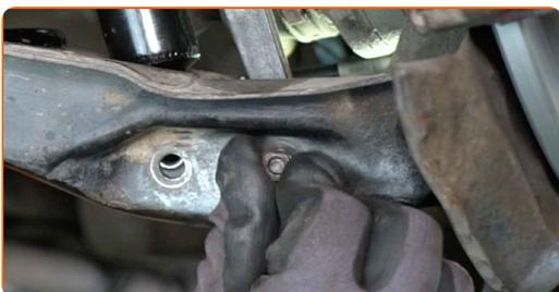
**39** Setzen Sie den Stoßdämpfer in den Radkasten und befestigen Sie diesen.
