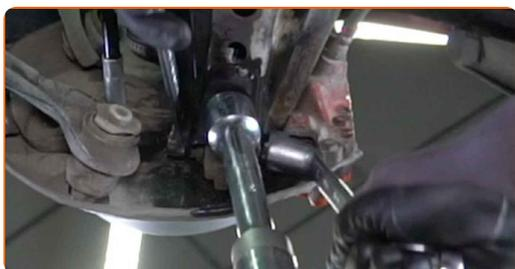
**24** Entfernen Sie die Stütze unter dem hinteren Querlenker.
