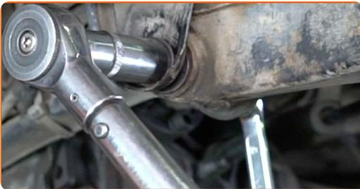
**46** Schrauben Sie die unteren Befestigungen des Stoßdämpfers fest. Verwenden Sie Ring-Gabelschlüssel Nr. 17. Verwenden Sie Stecknuss Nr. 17. Verwenden Sie einen Drehmomentschlüssel. Ziehen Sie ihn mit 55 Nm Drehmoment fest.
