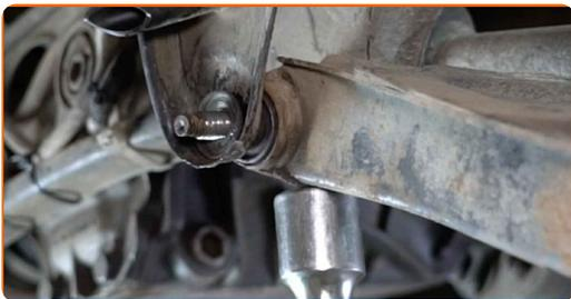
**37** Verbinden Sie die Koppelstange mit dem Achslenker.
