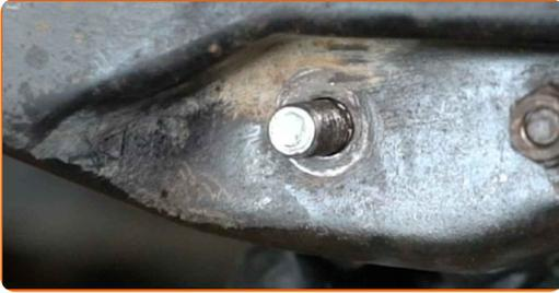
**43** Zum korrekten Anziehen der Befestigungen müssen Sie die Komponenten der Aufhängung in ihre Arbeitsposition heben.
