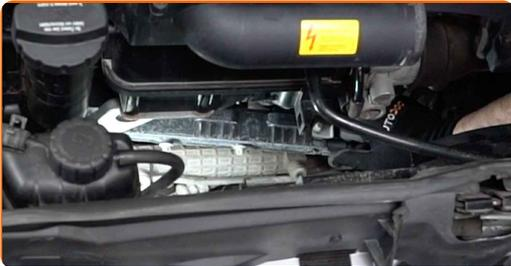
**4** Schrauben Sie die Zündspulenklammer ab. Verwenden Sie Stecknuss Nr. E11. Verwenden Sie einen Ratschenschlüssel.
