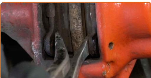
**12** Entfernen Sie die Bremsbeläge.
