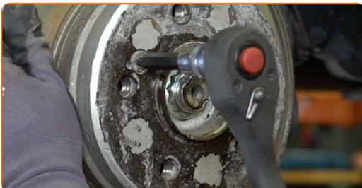
**19** Entfernen Sie die Befestigungsschraube.
