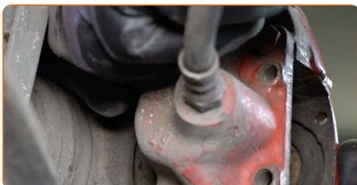
**16** Entfernen Sie den Bremssattel.
