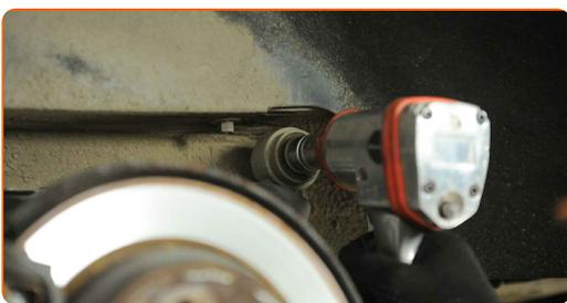
**Austausch: Stoßdämpfer – MERCEDES-BENZ VITO / MIXTO Kasten (W639).
