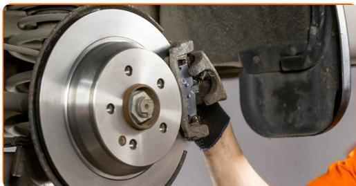
**19** Schrauben Sie die Führungsbolzen hinein.
