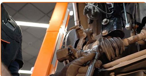
**27** Entfernen Sie die Rückholfeder der Bremsbeläge. Verwenden Sie einen flachen Schraubendreher.
