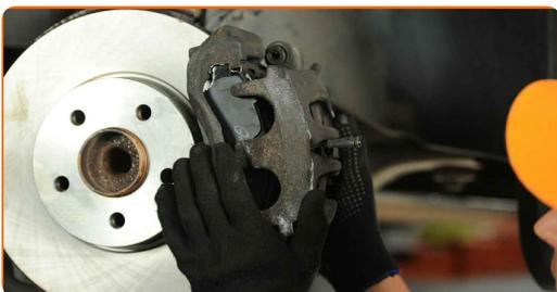
**33** Schrauben Sie die Führungsbolzen hinein.
