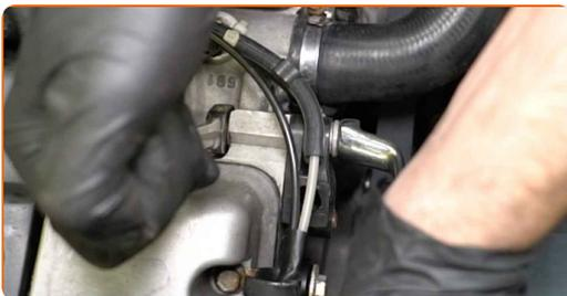
**4** Verwenden Sie eine Hebelstange mit dem richtigen Durchmesser, um den Spanner zu lösen und entfernen Sie die Befestigungsschraube. Verwenden Sie eine 3/8-Zoll-Vierkantantrieb-Verlängerungsstange.
