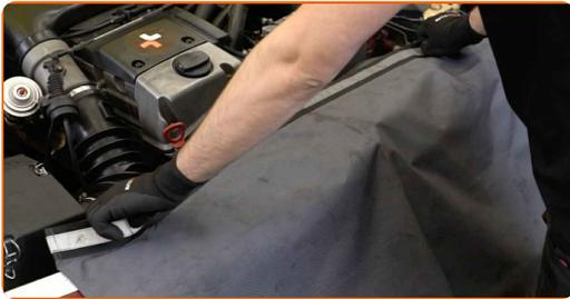
**3** Schrauben Sie die Befestigungsschraube des Riemenspanners ab. Verwenden Sie Ring-Gabelschlüssel Nr. 16 (2 Teile).
