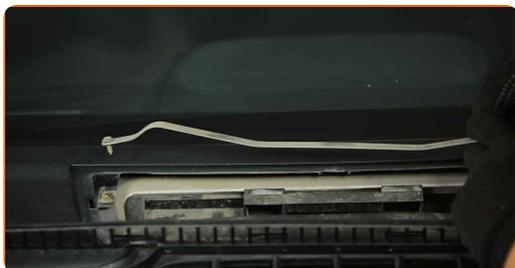
**25** Entfernen Sie die untere Windlaufabdeckung.
