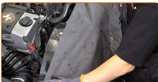
**3** Reinigen Sie den Befestigungssitz des Kraftstofffilters. Verwenden Sie Allzweckreinigungsspray.
