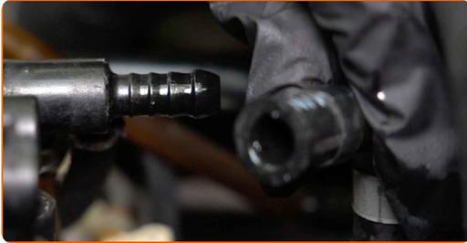
**13** Entlüften Sie die Kraftstoffanlage manuell. Verwenden Sie einen Kraftstoffpumpball.
