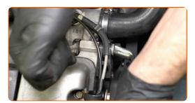
Verwenden Sie eine Hebelstange mit dem richtigen Durchmesser, um den Spanner zu lösen und entfernen Sie die Befestigungsschraube. Verwenden Sie eine 3/8-Zoll-Vierkantantrieb-Verlängerungsstange.
