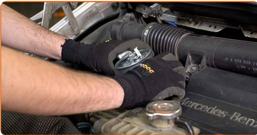
**Austausch: Kraftstofffilter – MERCEDES-BENZ SPRINTER 3-t Kasten (903).
