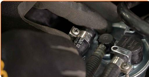
**15** Schrauben Sie das Befestigungselement ein, das die Kraftstoffversorgungsleitung mit dem Kraftstofffiltergehäuse verbindet. Verwenden Sie einen Kreuzschlitzschraubendreher.
