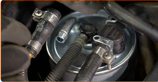
**14** Befestigen Sie die Leitung am Kraftstofffilter.
