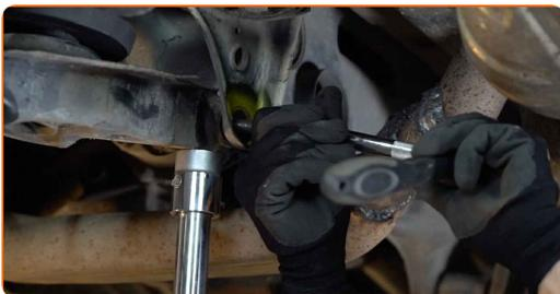
14 Entfernen Sie die Befestigungsschraube.
