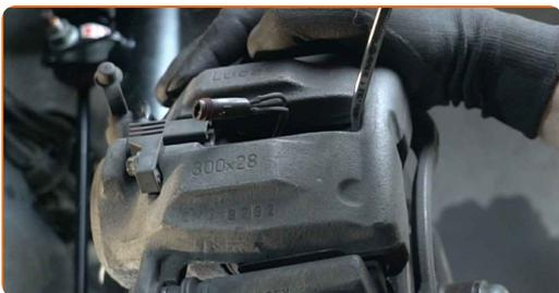
**11** Entfernen Sie den Bremssattel.
