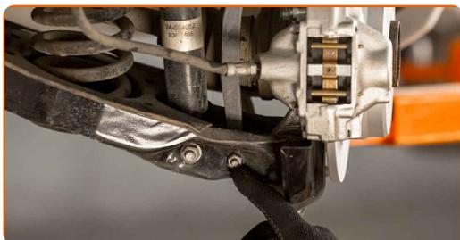
**9** Drehen Sie das Befestigungselement auf, das die Koppelstange mit dem Querlenker verbindet. Verwenden Sie Ring-Gabelschlüssel Nr. 13. Verwenden Sie Stecknuss Nr. 13. Verwenden Sie einen Ratschenschlüssel.
