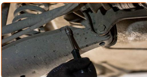
**7** Entfernen Sie die Kunststoffabdeckung des Querlenkers.
