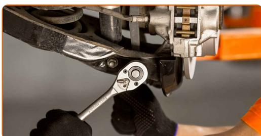
**10** Schrauben Sie das Befestigungselement heraus, das die Druckstange mit dem Stabilisator verbindet. Verwenden Sie Ring-Gabelschlüssel Nr. 17. Verwenden Sie Ring-Gabelschlüssel Nr. 19.
