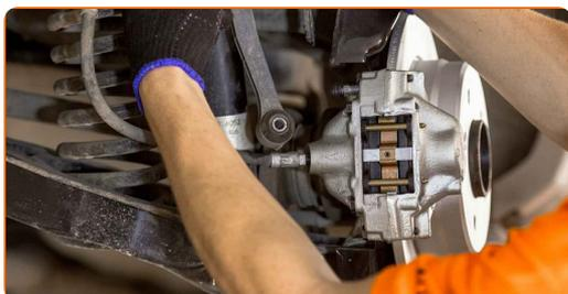
**12** Reinigen Sie die Montagesitze der Koppelstange. Benutzen Sie eine Drahtbürste. Benutzen Sie WD-40-Spray.
