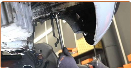
**23** Montieren Sie den Stabilisator.
