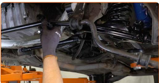
**24** Bringen Sie die Stabilisatorbuchsenhalter an. Verwenden Sie eine Wasserpumpenzange.
