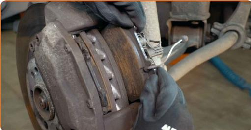
**Austausch: Bremsbeläge – MERCEDES-BENZ S-Klasse Limousine (W220).**
