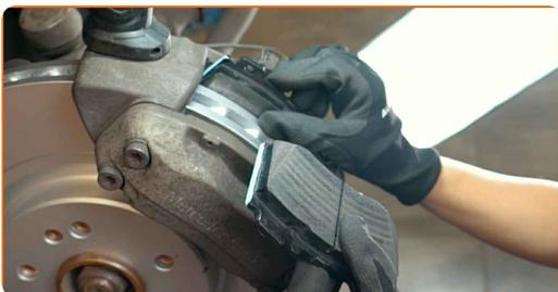
Austausch: Bremsbeläge – MERCEDES-BENZ S-Klasse Limousine (W220).
