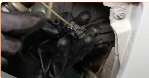
**7** Setzen Sie eine Glühlampe in ein neues Blinklicht ein.
