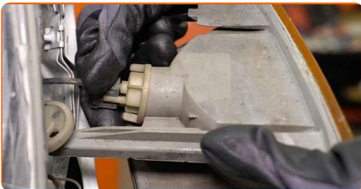
**5** Trennen Sie den Steckverbinder des Blinklichts.
