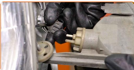
**6** Behandeln Sie den Steckverbinder des Blinklichts mit Kontaktspray. Verwenden Sie dielektrisches Fett.
