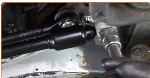
**36** Ziehen Sie die Spurstangenkopf Sicherungsmutter an. Verwenden Sie Ring-Gabelschlüssel Nr. 19. Verwenden Sie Ring-Gabelschlüssel Nr. 22. Verwenden Sie einen Drehmomentschlüssel. Ziehen Sie ihn mit 50 Nm Drehmoment fest.
