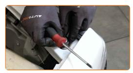
Schrauben Sie die oberen Befestigungsschrauben des Scheinwerfers ein. Verwenden Sie einen Kreuzschlitzschraubendreher.
