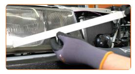
Schrauben Sie die oberen Befestigungsschrauben des Scheinwerfers ab. Verwenden Sie einen Kreuzschlitzschraubendreher.
