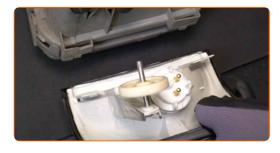
Montieren Sie den Blinker an dem neuen Scheinwerfer.
