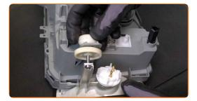
Entfernen Sie die hintere Abdeckung des neuen Scheinwerfers.
