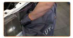
Schrauben Sie die Befestigungsschraube der Scheinwerferleiste ab. Verwenden Sie einen Kreuzschlitzschraubendreher.
