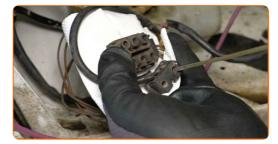
Reinigen Sie den Stecker des Scheinwerfers. Verwenden Sie dielektrisches Fett.
