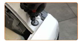
Schrauben Sie die untere Befestigungsschraube des Scheinwerfers ein. Verwenden Sie Stecknuss Nr. 10. Verwenden Sie einen Ratschenschlüssel.
