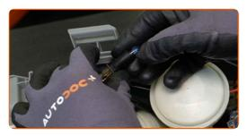
Ziehen Sie die Halteklammer der Nebelscheinwerferlampe beiseite.
