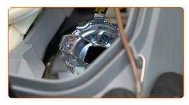
Setzen Sie die Nebelscheinwerferlampe ein.
