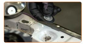
Schrauben Sie die untere Befestigungsschraube des Scheinwerfers ab. Verwenden Sie Stecknuss Nr. 10. Verwenden Sie einen Ratschenschlüssel.
