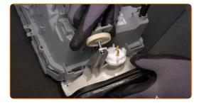
17 Schrauben Sie die Rändelmutter des Blinkers auf.
