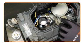
Setzen Sie die Abblend- und Fernlichtlampe ein.
