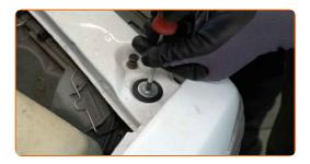
7 Entfernen Sie die Befestigungsschrauben.
