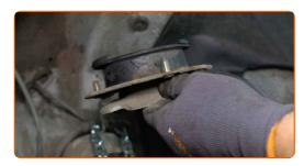
Säubern Sie den Montagesitz des Domlagers. Benutzen Sie eine Drahtbürste. Verwenden Sie Allzweckreinigungsspray.
