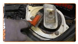
Reinigen Sie die Befestigungsmutter der Kolbenstange des Federbeins. Benutzen Sie eine Drahtbürste. Benutzen Sie WD-40-Spray.
