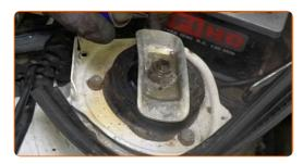
Lösen Sie die Schraubbefestigung der Kolbenstange des Federbeins. Verwenden Sie eine spezielle Schraubnuss, um den Stoßdämpfer zu entfernen Nr. 22. Verwenden Sie Inbusschlüssel Nr. H7. Verwenden Sie einen Ratschenschlüssel.
