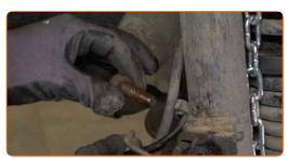
Lösen Sie das Federbein vom Achsschenkel. Benutzen Sie ein Brecheisen.
