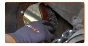
Reinigen Sie die Anbringungssitze des Federbeins. Benutzen Sie eine Drahtbürste. Verwenden Sie Allzweckreinigungsspray.
