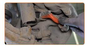
Schrauben Sie die unteren Federbeinbefestigungen ab. Verwenden Sie Ring-Gabelschlüssel Nr. 19. Verwenden Sie Stecknuss Nr. 19. Verwenden Sie einen Ratschenschlüssel.
