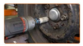
Senken Sie das Auto und ziehen Sie die Radschrauben über Kreuz an. Verwenden Sie eine Schlagnuss für Felgen # 17. Verwenden Sie einen Drehmomentschlüssel. Ziehen Sie ihn mit 110 Nm Drehmoment fest.
