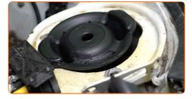
Schrauben Sie die Schraubbefestigungen des oberen Domlagers an.
