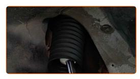
Montieren Sie den Stoßdämpfer.
