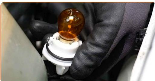
**14** Setzen Sie die Fassung der Blinkerlampe ein, indem Sie sie um ca. 30° drehen.
