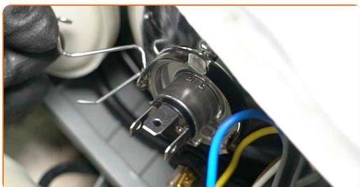
**9** Entfernen Sie die Ablend- und Fernlichtlampe.
