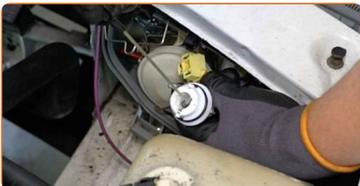
**13** Setzen Sie eine neue Blinkerlampe in die Fassung ein.
