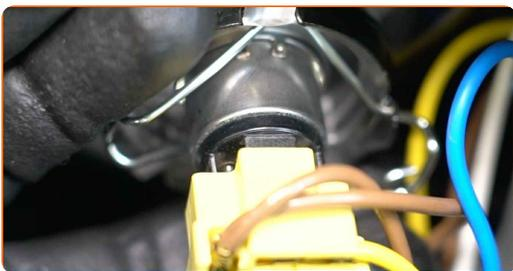
**18** Setzen Sie eine neue Nebelscheinwerferlampe ein.
