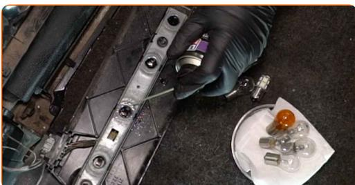
**29** Setzen Sie die neuen Glühlampen in die Fassungen auf dem Lampenträger ein.
