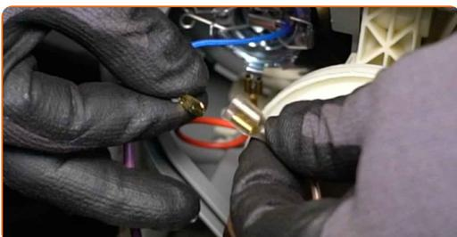
**5** Ziehen Sie die Halteklammer der Nebelscheinwerferlampe beiseite.
