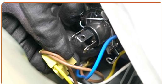
**8** Ziehen Sie die Halteklammer der Ablend- und Fernlichtlampe beiseite.
