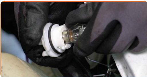
**11** Entfernen Sie die Blinkerlampe.
