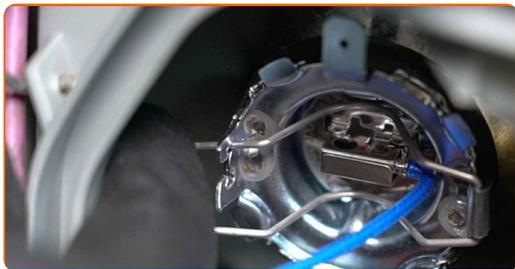
**6** Entfernen Sie die Nebelscheinwerferlampe.
