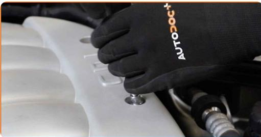
**5** Entfernen Sie den hinteren Teil der Motorabdeckung.
