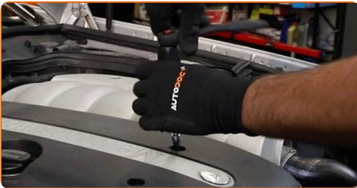
**4** Schrauben Sie die Befestigungen des hinteren Teils der Motorabdeckung ab. Verwenden Sie Stecknuss Nr. 10. Verwenden Sie einen Ratschenschlüssel.
