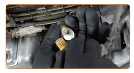
Reinigen Sie die Befestigung der Lambdasonde. Benutzen Sie eine Drahtbürste. Benutzen Sie WD-40-Spray.
