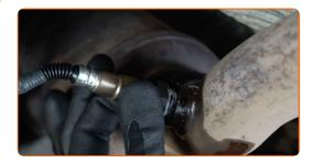
Ziehen Sie die Befestigung der Lambdasonde fest. Verwenden Sie Ring-Gabelschlüssel Nr. 22. Verwenden Sie einen Drehmomentschlüssel. Ziehen Sie ihn mit 51 Nm Drehmoment fest.
