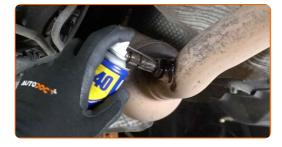
Lösen Sie die Befestigung der Lambdasonde. Verwenden Sie eine 22 mm Lambdasondenstecknuss. Verwenden Sie einen Ratschenschlüssel.
