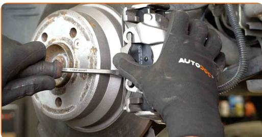
**13** Verteilen Sie die Bremsbeläge. Benutzen Sie ein Brecheisen.
