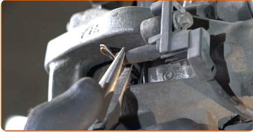
**10** Entfernen Sie die Staubschutzkappen der Bremssattel-Führungsstifte. Benutzen Sie ein Brecheisen.
