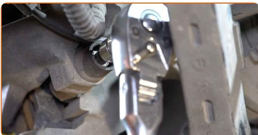
**12** Lösen Sie die Bremssattel-Haltefeder. Benutzen Sie ein Brecheisen.
