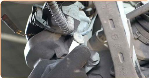
**11** Schrauben Sie die Befestigung des Bremssattels ab. Verwenden Sie Inbusschlüssel Nr. H7. Verwenden Sie einen Ratschenschlüssel.
