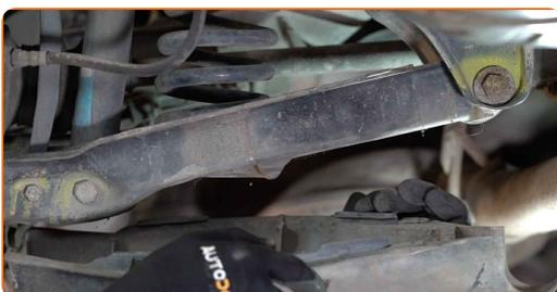
8 Reinigen Sie die Befestigungen des Querlenkers. Benutzen Sie eine Drahtbürste. Benutzen Sie WD-40-Spray.
