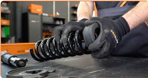
20 Setzen Sie eine neue Spiralfeder in den Federspanner ein.
