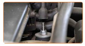
Reinigen Sie die obere Befestigung des Stoßdämpfers. Benutzen Sie eine Drahtbürste. Benutzen Sie WD-40-Spray.
