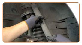
Reinigen Sie die Stoßdämpferaufnahmen. Benutzen Sie eine Drahtbürste.
