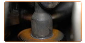
Ziehen Sie die Radschrauben unter Verwendung eines Kreuzmusters an. Verwenden Sie eine Schlagnuss für Felgen # 17. Verwenden Sie einen Drehmomentschlüssel. Ziehen Sie ihn mit 110 Nm Drehmoment fest.
