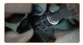
Schrauben Sie die oberen Befestigungen des Stoßdämpfers ab.
