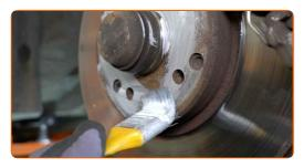
Die Bremsscheibenoberfläche reinigen. Benutzen Sie einen Bremsenreiniger.
