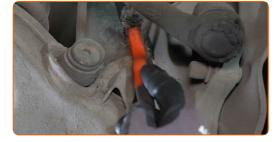
Stützen Sie den Querlenker. Benutzen Sie einen hydraulischen Getriebeheber.
