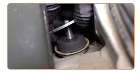
Entfernen Sie die Elemente der oberen Befestigung des Stoßdämpfers.
