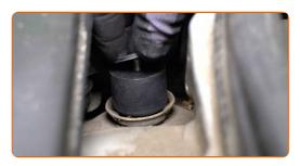
Schrauben Sie das obere Befestigungselement des Stoßdämpfers ein.
