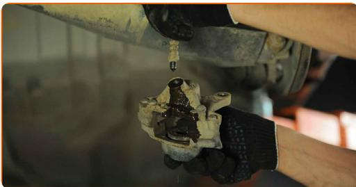
**17** Behandeln Sie den Bremsschlauch. Benutzen Sie einen Bremsenreiniger.
