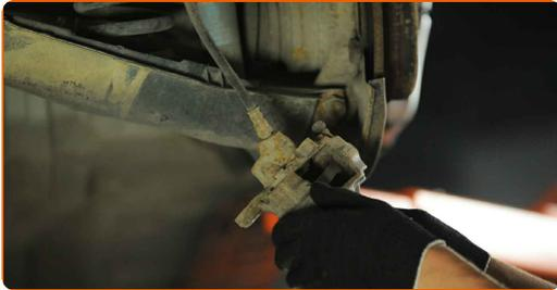
**16** Trennen Sie den Bremsschlauch.
