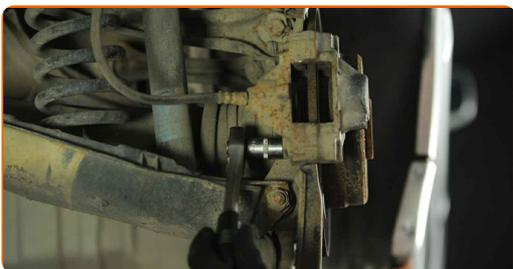
**14** Entfernen Sie die Befestigungsschrauben (2 Stück).
