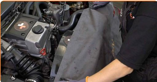
**3** Lösen Sie die Befestigungsclips der Luftfilterabdeckung.
