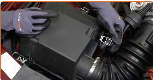
**4** Entfernen Sie die Abdeckung des Luftfilters.
