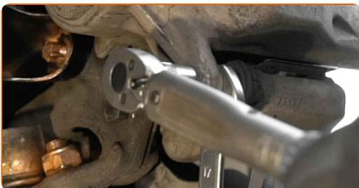
**23** Behandeln Sie den Stecker des Bremsbelagverschleißsensors. Verwenden Sie dielektrisches Fett.
