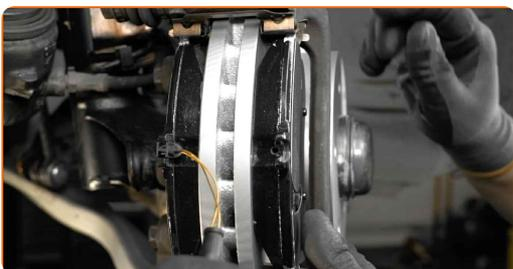
**20** Installieren Sie den Bremssattel und fixieren Sie diesen.
