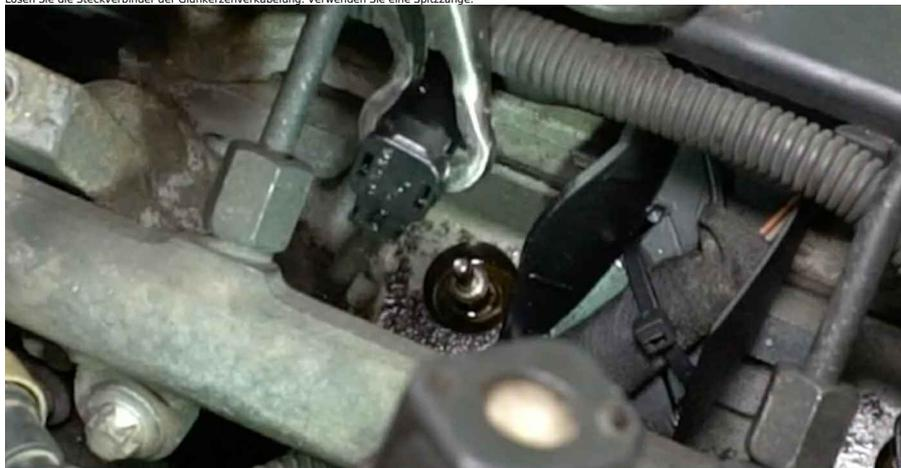
11 Entfernen Sie Schmutz, Staub und Ablagerungen von den Zündkerzenbohrung.
