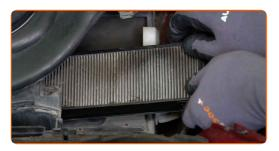
Montieren Sie die Innenraumfilter.
