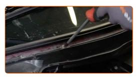
Setzen Sie das Gummiformteil der Windschutzscheibe ein.
