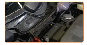
Bringen Sie die Dichtung der Wasserkastenabdeckung an.
