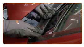
Setzen Sie das mittlere Element ein, das die Dichtung der Wasserkastenabdeckung hält.
