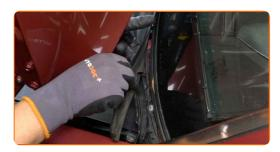
Schrauben Sie die Befestigungsschrauben des Ablaufs ab. Verwenden Sie einen Kreuzschlitzschraubendreher.
