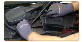
Drücken Sie auf die Halterung des Innenraumfilters, um sie zu lösen.
