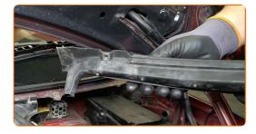
7 Entfernen Sie den mittleren Teil des Ablaufs.
