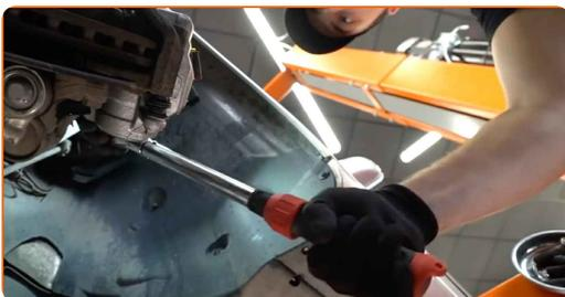
33 Ziehen Sie den Bremsschlauchhalter fest. Verwenden Sie Ring-Gabelschlüssel Nr. 14. Verwenden Sie einen Drehmomentschlüssel. Ziehen Sie ihn mit 18 Nm Drehmoment fest.
