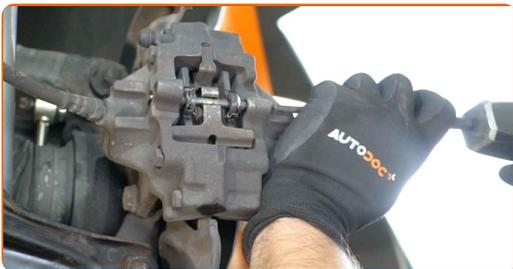
**9** Entfernen Sie die Rückholfeder der Bremsbeläge.
