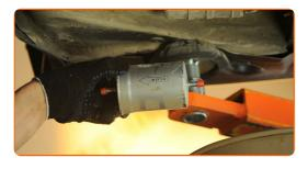
Installieren Sie einen neuen Kraftstofffilter.
