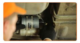
Ziehen Sie die Befestigungsklemme der Kraftstoffversorgungsleitung an. Verwenden Sie einen flachen Schraubendreher.
