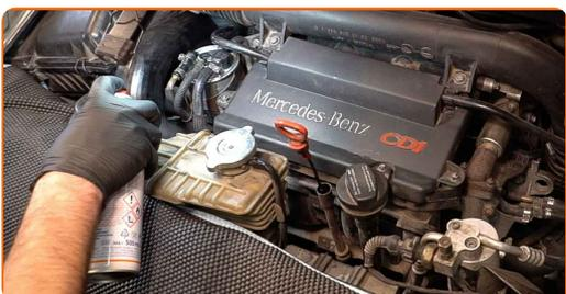
**10** Schrauben Sie den Ölfilter ab. Verwenden Sie Steckschlüssel 76-14F. Verwenden Sie einen Ratschenschlüssel.
