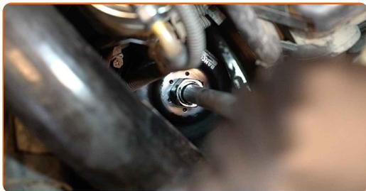
**11** Entfernen Sie den Ölfilter. Legen Sie den alten Ölfilter in den Behälter.
