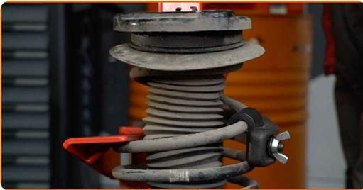
**24** Reinigen Sie die Kolbenstange des Federbeins. Benutzen Sie eine Drahtbürste. Benutzen Sie WD-40-Spray.
