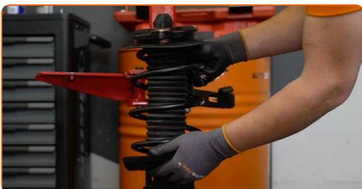
**39** Reinigen Sie die Anbringungssitze des Federbeins. Benutzen Sie eine Drahtbürste. Benutzen Sie WD-40-Spray.
