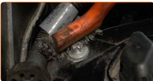
**4** Lösen Sie die oberen Befestigungen des Federbeins. Verwenden Sie den Torx E12. Verwenden Sie einen Ratschenschlüssel.
