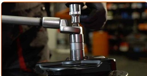
**35** Dekomprimieren Sie die Feder.
