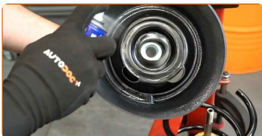
**33** Setzen Sie das neue obere Federbeinlager ein.
