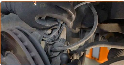
**14** Trennen Sie die Verkabelung des ABS-Sensors.
