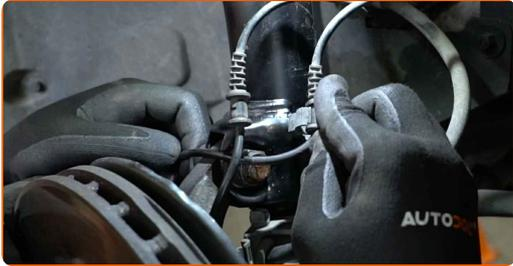
**53** Verbinden Sie das Bremsbelagverschleißkabel.
