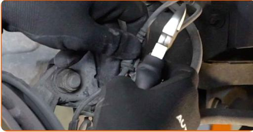
**15** Trennen Sie das Bremsbelagverschleißkabel ab.
