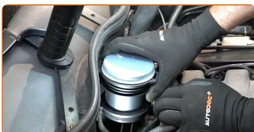
**15** Schließen Sie die Halteklammern des Luftmassenmessers.
