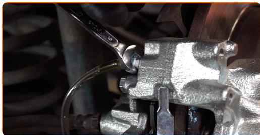
**34** Trennen Sie den Schlauch des Bremsentlüftungs-Kits.
