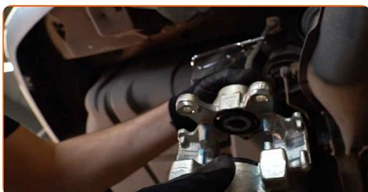
**22** Installieren Sie den Bremssattel und fixieren Sie diesen.
