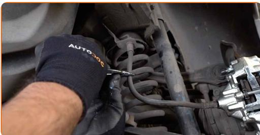
**28** Lösen Sie die Bremsentlüftungsschraube. Verwenden Sie Ring-Gabelschlüssel Nr. 9.
