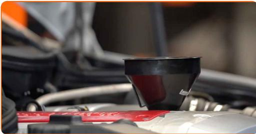
**28** Schrauben Sie die Kappe an. Verwenden Sie Steckschlüssel 76-14F. Verwenden Sie einen Drehmomentschlüssel. Ziehen Sie ihn mit 25 Nm Drehmoment fest.
