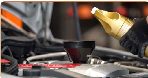
**29** Schrauben Sie die Öleinfüllschraube ab. Setzen Sie den Trichter ein.
