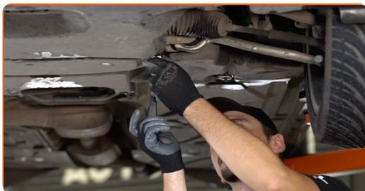
11 Lösen Sie die Befestigungen der unteren Ölwanne-Abdeckung. Verwenden Sie Stecknuss Nr. 8. Verwenden Sie einen Ratschenschlüssel.
