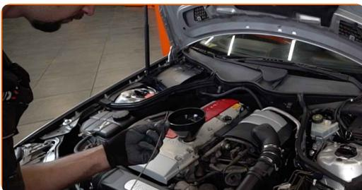
**30** Füllen Sie neues Öl in der vom Fahrzeughersteller empfohlenen Menge in den Motor ein.
