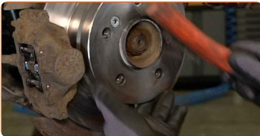
**45** Behandeln Sie die Oberfläche, an der die Bremsscheibe die Felge berührt. Verwenden Sie Keramikfett.
