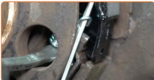
**32** Reinigen Sie die Radnabe. Benutzen Sie eine Drahtbürste.
