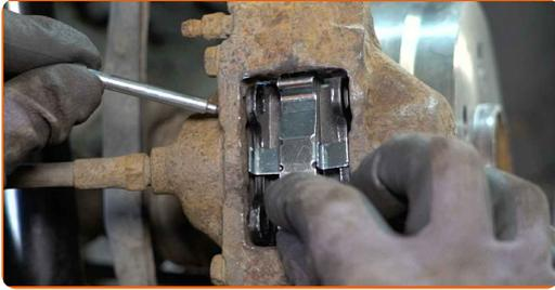
**43** Montieren Sie die Führungsbolzen der Bremsbeläge. Verwenden Sie einen Splintentreiber. Benutzen Sie einen Hammer.
