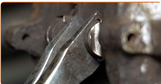
**12** Entfernen Sie die Bremsbeläge.
