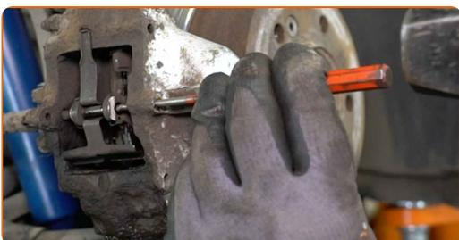
**10** Entfernen Sie die Rückholfeder der Bremsbeläge.
