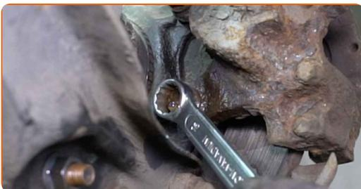
**15** Entfernen Sie die Befestigungsschrauben.
