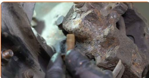
**16** Entfernen Sie den Bremssattel.
