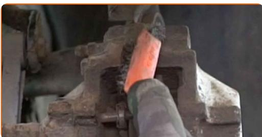
**9** Entfernen Sie den Bremsbelagbolzen. Verwenden Sie einen Splintentreiber. Benutzen Sie einen Hammer.
